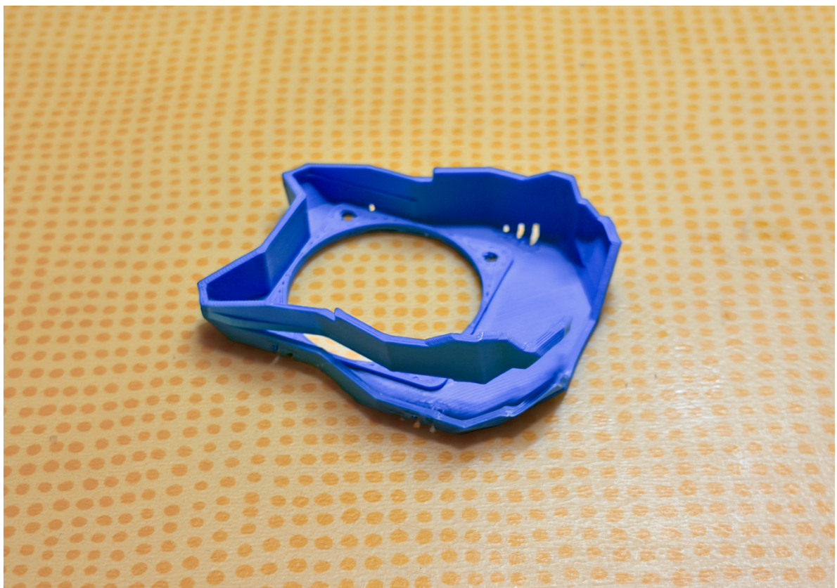
Obr. 8 – Chyba pri tlači materiálu ABS
